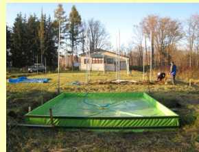
母子里の融雪観測室 (手前は3.6m×3.6mの大型積雪ライシメーター)
