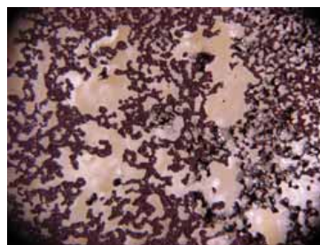
図 2. 実験前 (上) と実験終了後 (下) の片薄片写真。空隙が黒色、氷が白色で示されている。下図の大きな白い部分は融雪水が通った跡である。
