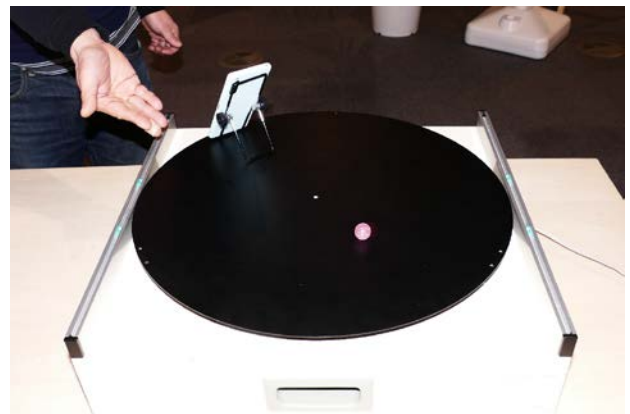
写真 2. 回転実験台を利用した実験例（実験台を回さずにボールを転がした対照実験）
