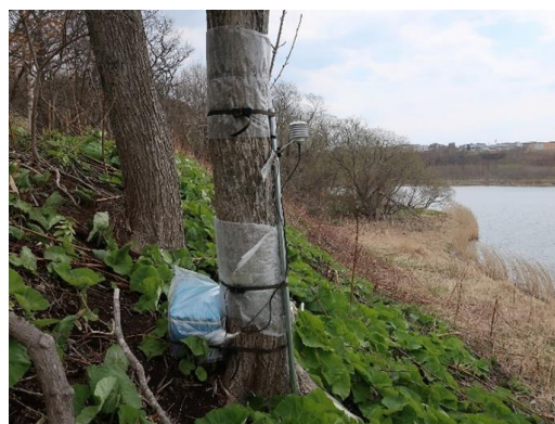
図8. 湖岸に設置したインターバルカメラと気温測定用の温度計
