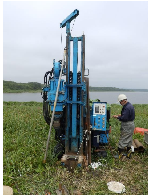
図5. 無水式土壌・地下水調査機エコプローブ(EP-26型)による掘削の様子 (生花苗沼)。
