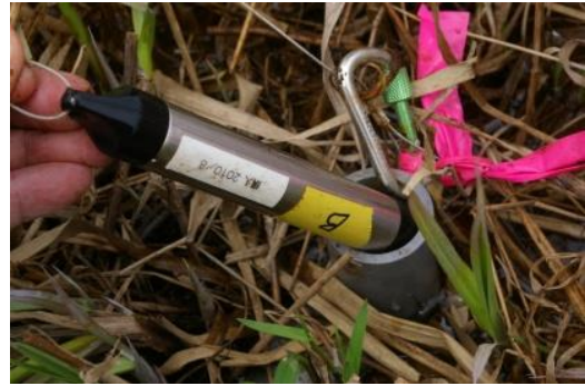
図 6. 浮島に挿入した塩ビパイプ内に絶対圧水位計を吊り下げる様子。
