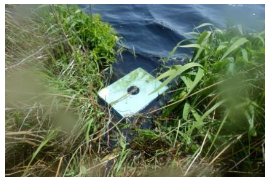
図 7. 水温データロガーを吊り下げた浮き。
